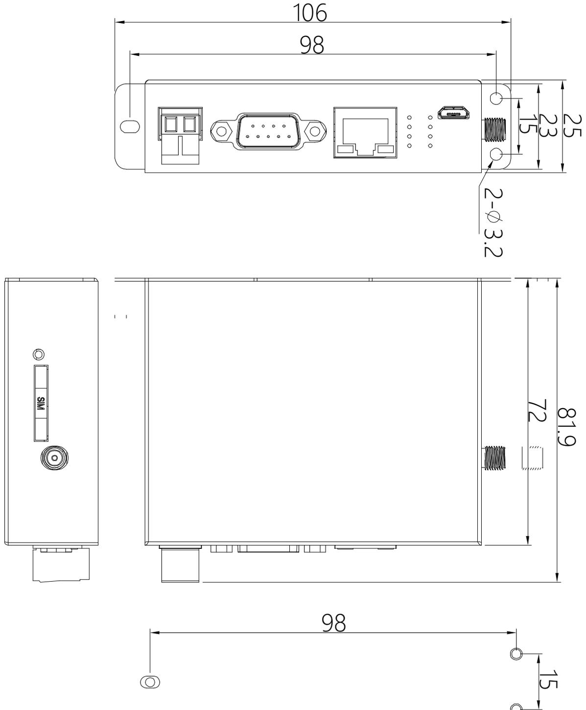
安装面板上开三个固定孔（直径为2.5mm）
