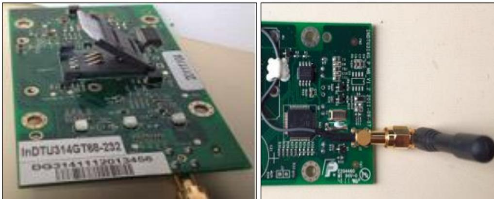
图 2-8 InDTU314/317 安装 SIM 卡与天线
