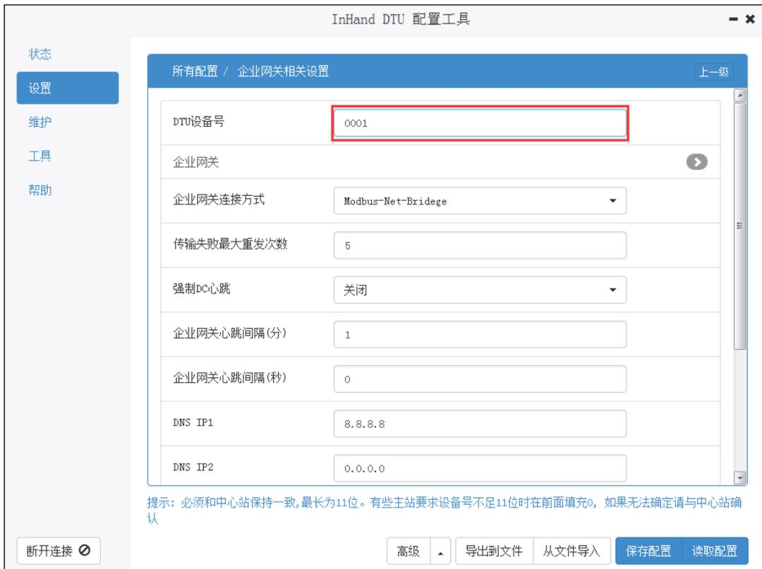
图 5-36 Modbus-Net-Bridge 配置 4
