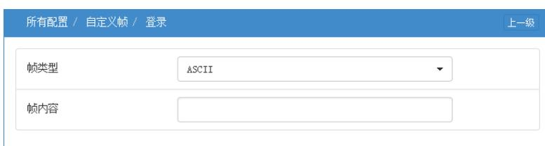
帧类型 ASCII、HEX、上海协议三种可选，上海协议中 DTU 设备在与主站建立连接的过程中，需要先向主站发送登陆帧，把 101 链路地址和专网卡的 IP 地址绑定在一起。上海协议的登陆帧数据格式如下 10 02 01 00 03 16，同 101 固定帧格式，中间的标红色的部分，表示链路地址为 0x0001。上图中的帧内容，需要填写链路地址，范围 0-65535。
