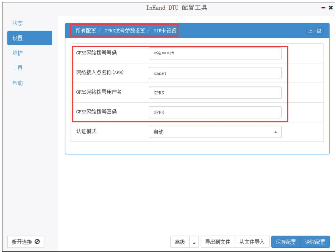
图 5-3 设置 SIM 卡参数
