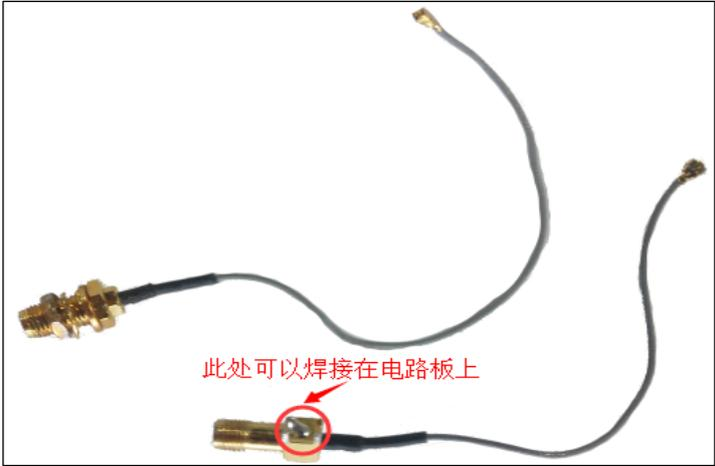
图 2-6 InDTU323 可焊接款天线
