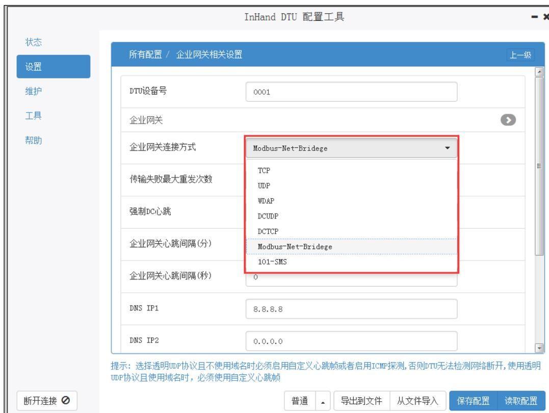
图 5-33 Modbus-Net-Bridge 配置 1
