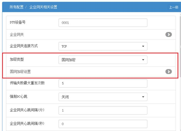
第三步：配置终端设备序列号，并打开证书管理工具。终端设备序列号，一般可以从终端设备铭牌获取，不同终端类型采用不同命名规则；如配网 DTU、FTU 序列号：
