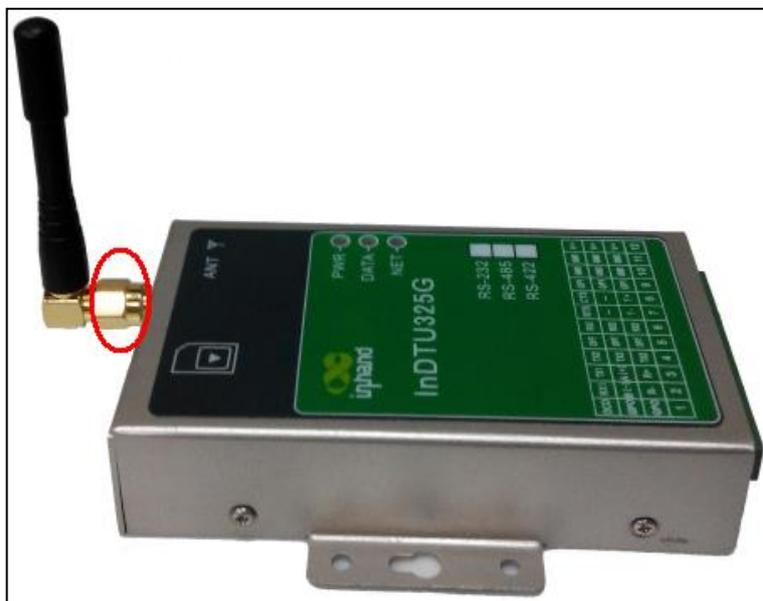
图 2-11 InDTU325 安装天线
