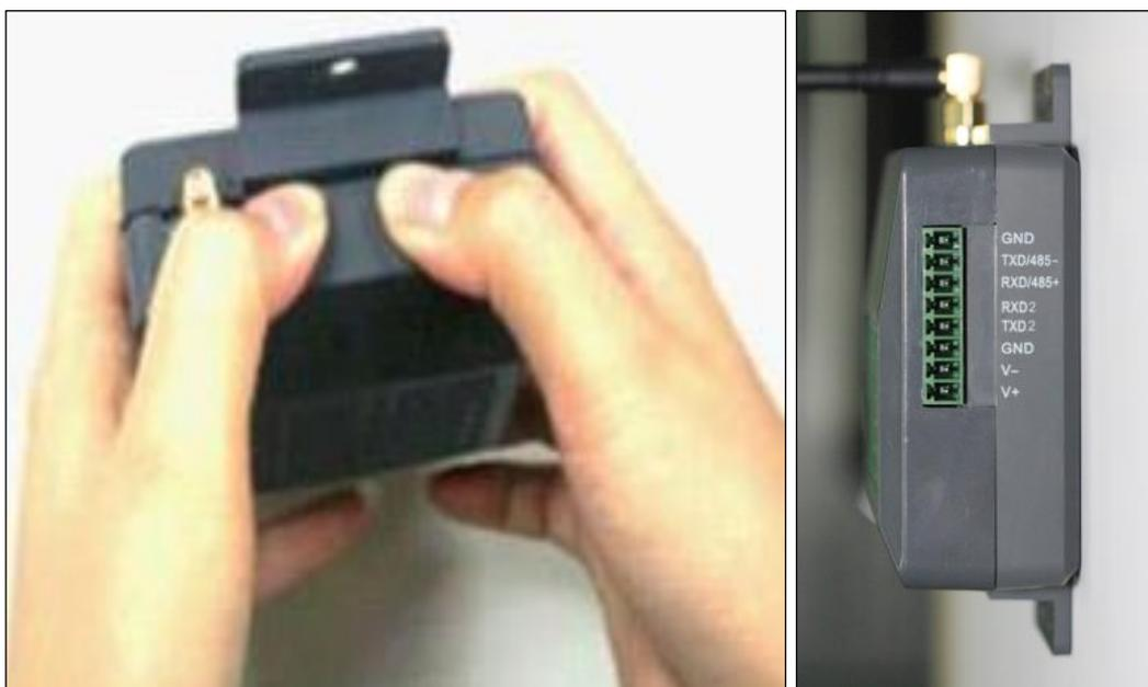
图 2-1 DTU 拆卸图示（左）和 DTU 接口端子（右）
