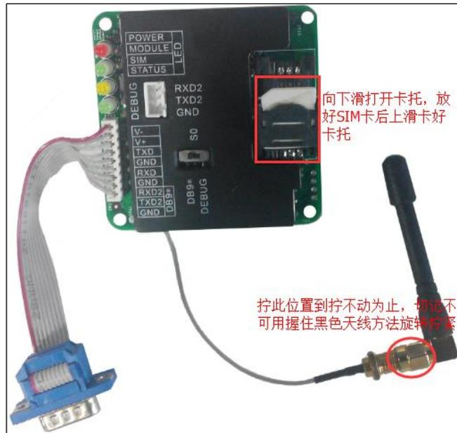
图 2-4 InDTU331 SIM 卡和天线安装
