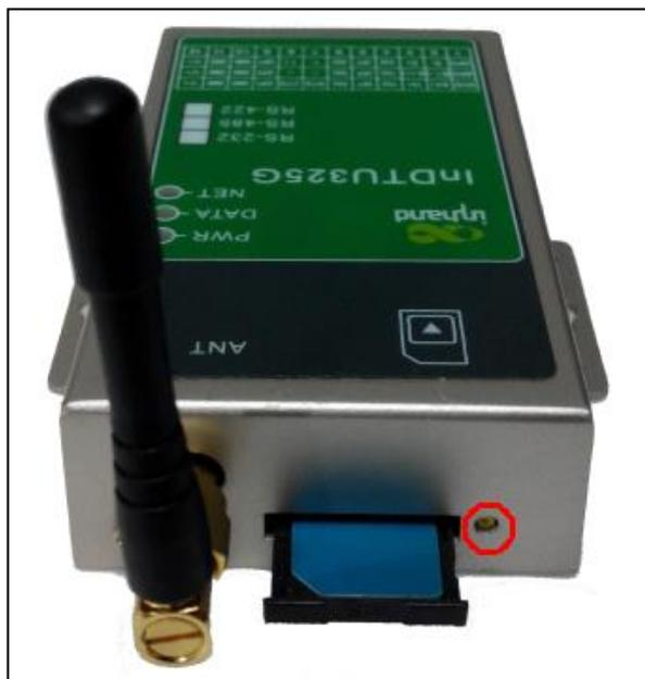
图 2-10 InDTU325 SIM 卡安装
