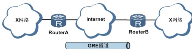
随着 IPv4 网络的广泛使用，为了使某些网络层协议的报文能够在 IPv4 网络中传输，可以将这些报文通过 GRE 技术进行封装，解决异种网络的传输问题。
