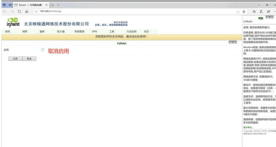
图 4 关闭SIM卡拨号功能
