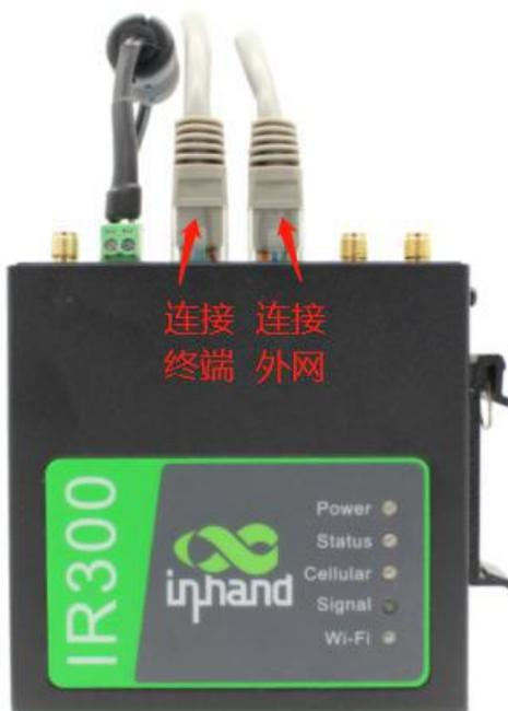
图 4-1-1 设备连线示意图
