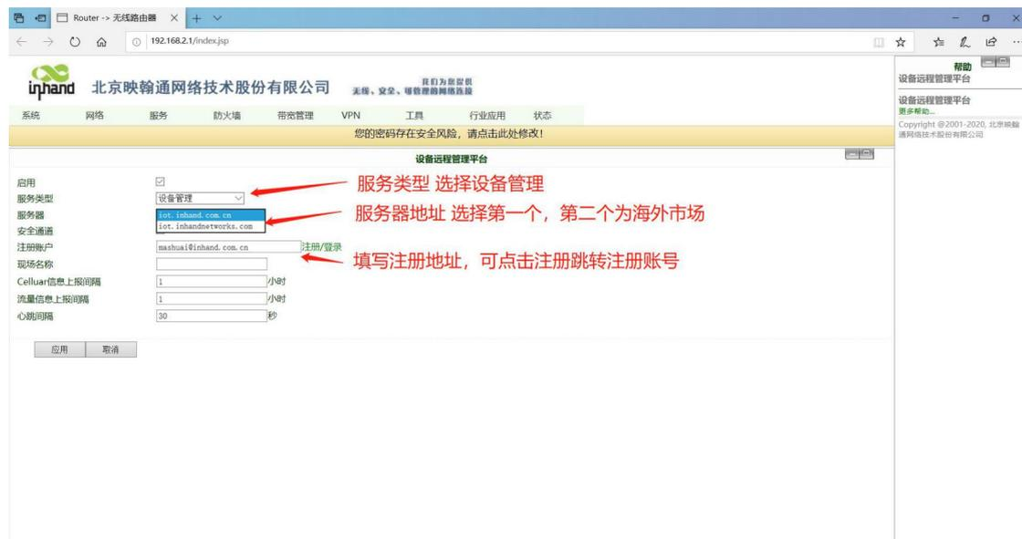
图 5-1-1 设备界面远程平台参数配置
