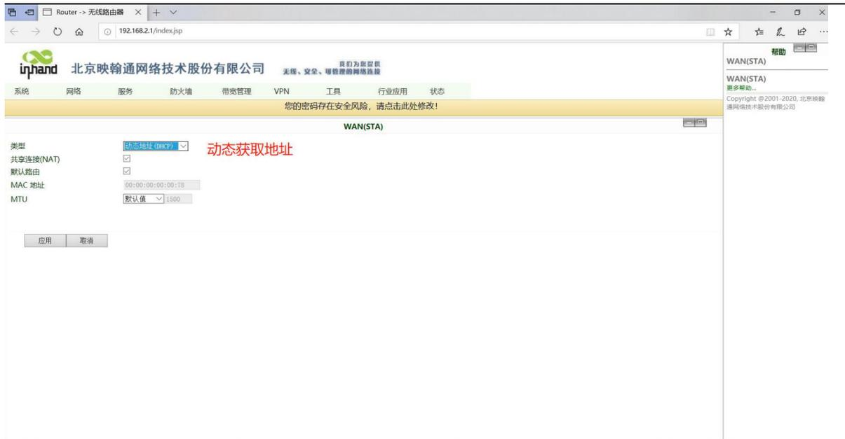
图 4-3-5-a 动态获取WAN ( STA) 地址示意图
