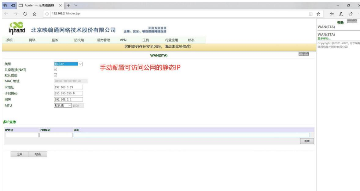
图 4-3-5-b 手动配置WAN ( STA) 地址示意图
