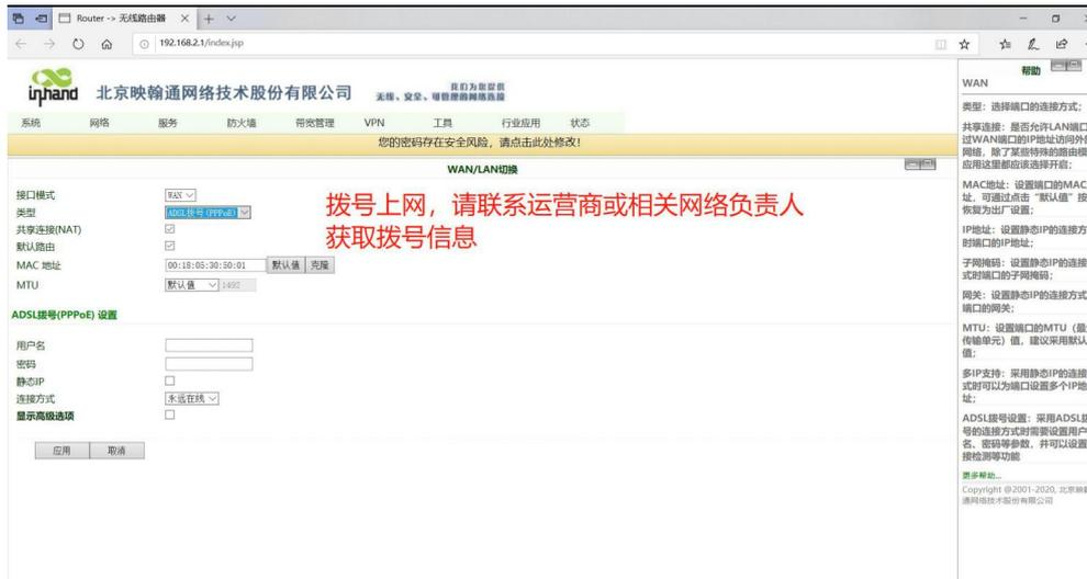
图 4-1-4-c ADSL拨号上网示意图
