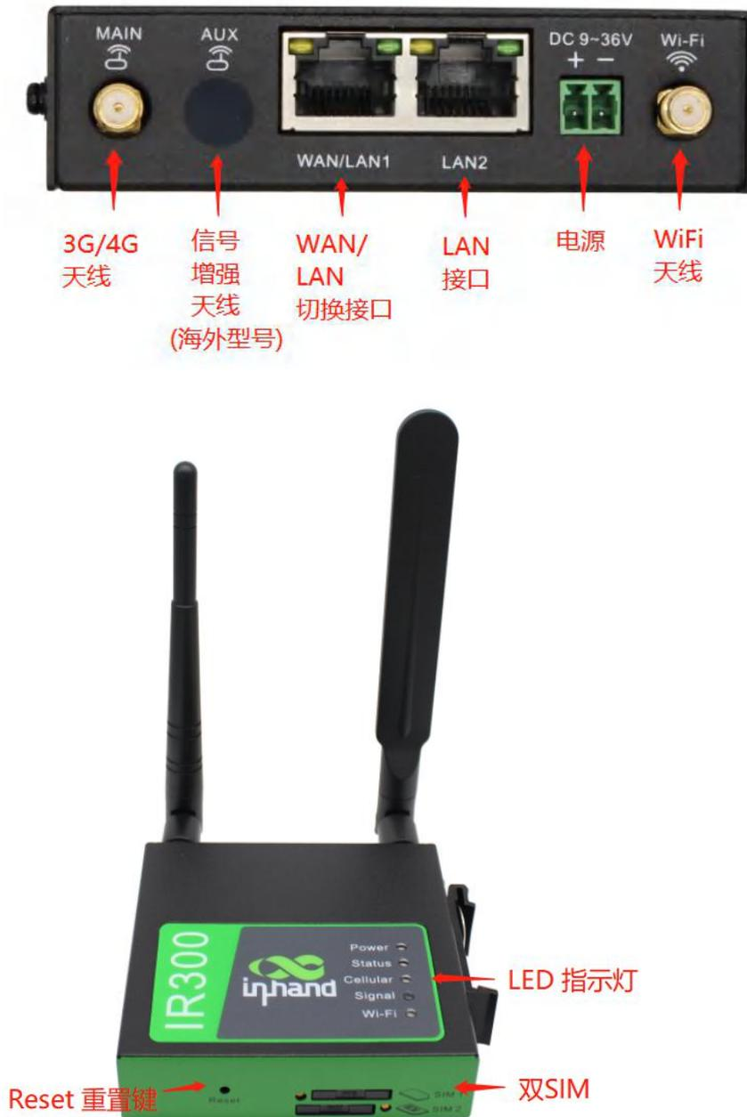
图 2-1 设备面板示意图
