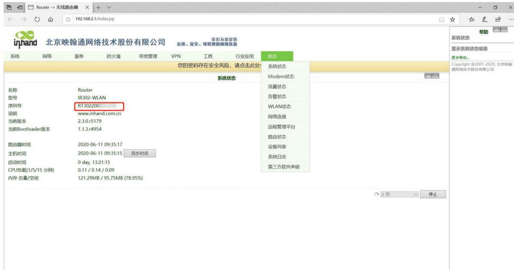
图 5-2-3-b 序列号查询示意图
