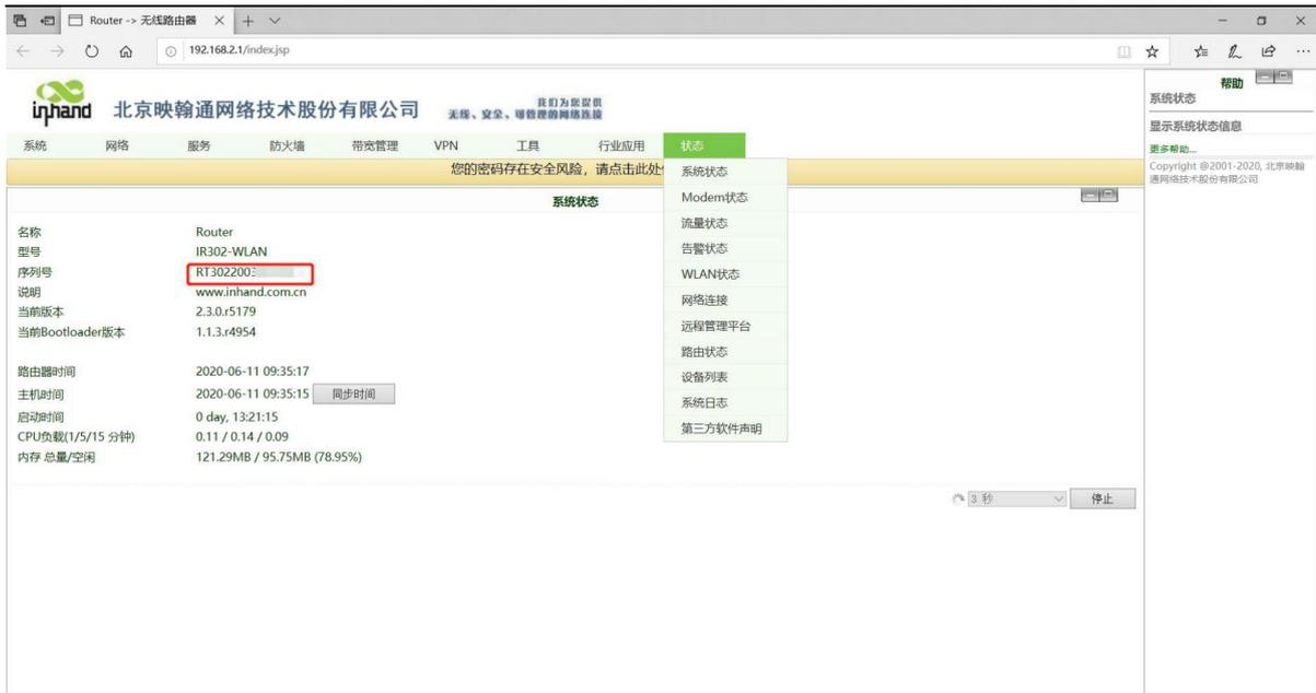
图 5-3-b 序列号查询示意图
