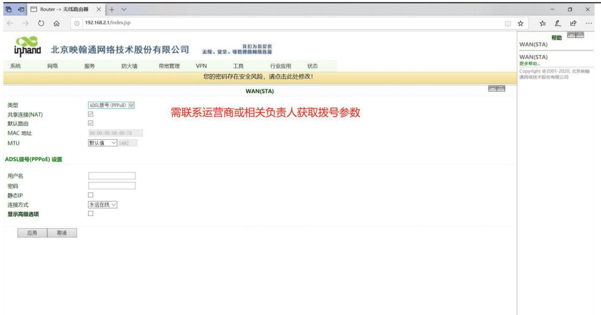
图 4-3-5-c ADSL拨号获取WAN ( STA ) 口设置
