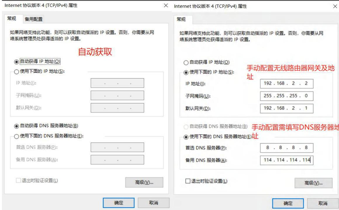
图 4-1-2 动态获取/手动配置示意图
