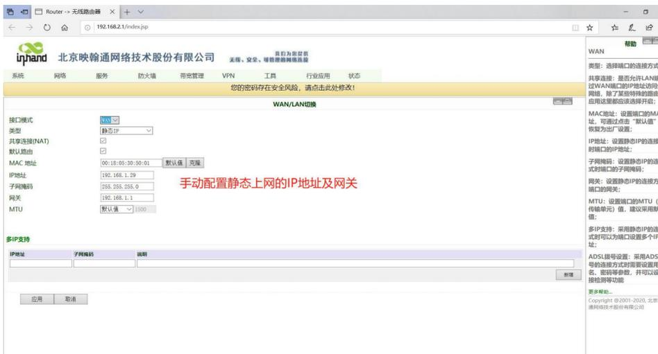
图 4-1-4-b 静态IP配置WAN口地址示意图
