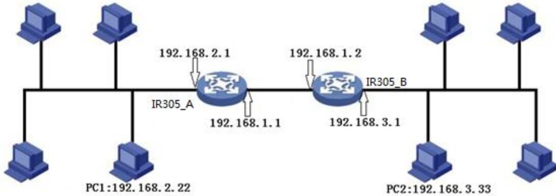
第一步：配置 IR305\_A。点击“网络>>OSPF”，“路由 ID”自定义填写但保证与 IR305\_B 在一个网段。在“网络”表中配置 IR305\_A，宣告该设备的路由条目。
